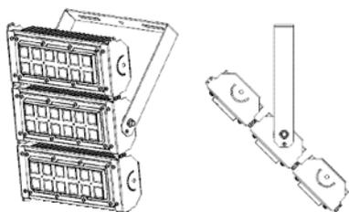
Ajuste o ângulo de inclinação da alça do projetor, em seguida aperte os parafusos M6 e M3 para fazer o travamento da alça. Em seguida instale o projetor no local desejando, fazendo a fixação do mesmo através de parafusos. Realize a ligação com a rede elétrica conforme indicado neste documento.
